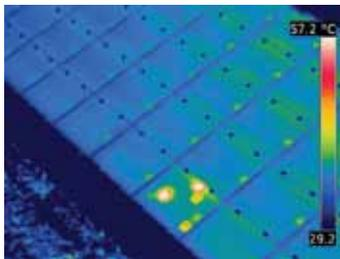
*Esta termografía muestra un ejemplo del "patrón mosaico", que indica que este panel posee un diodo de derivación defectuoso.*
