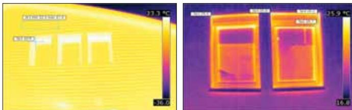
*El intervalo de la termografía ajustada automáticamente de la izquierda es demasiado amplio. La termografía ajustada de forma manual de la derecha muestra claramente una fuga de calor que era prácticamente invisible en la termografía ajustada de forma automática.*
