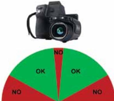
Ángulo de visión recomendado (verde) y a evitar (rojo) al realizar inspecciones termográficas.
