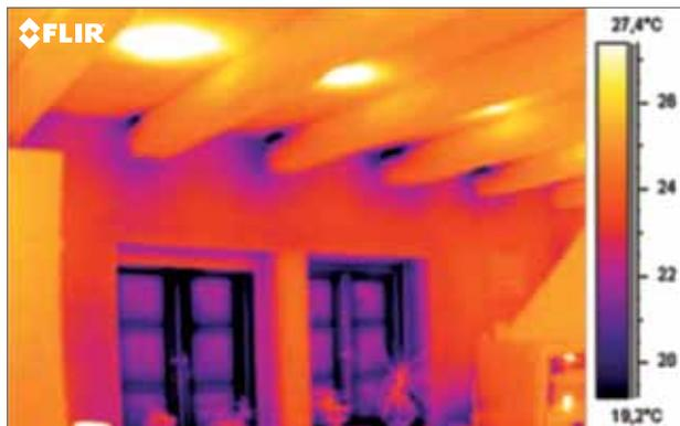
La termografía muestra puentes térmicos entre las vigas del techo y las paredes adyacentes.
