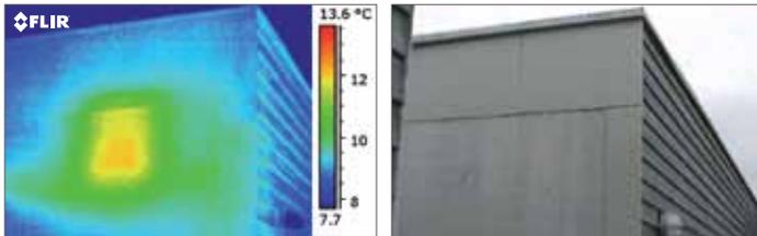
Este edificio está más cálido en su interior. Es una construcción sándwich: hormigón - aislamiento - hormigón. Falta una sección de aislamiento, lo que no se puede apreciar visualmente desde el interior o el exterior. Aquí la termografía puede ver lo que el ojo humano no puede.
