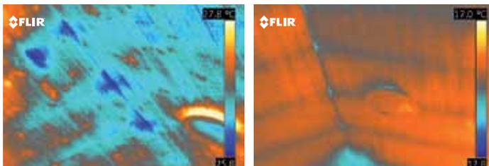
*Imágenes termográficas tomadas del mismo techo. En la imagen de la izquierda, la temperatura de la habitación ha cambiado rápidamente por la calefacción, lo que hace que la humedad sea claramente visible en la termografía.*
