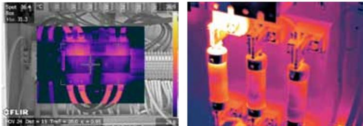
*Las cámaras termográficas de FLIR se utilizan para inspeccionar la instalación solar, incluyendo los cables, conectores, cajas de fusibles e inversores, en otras palabras: el sistema completo.*
