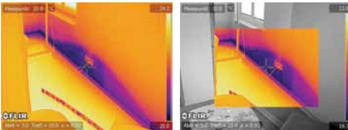
*Este caso de daños causados por el agua muestra claramente los beneficios de la función imagen-en-imagen, ya que el cliente puede ver fácilmente dónde se ha tomado la termografía, dato que sería mucho más difícil de conocer únicamente con la termografía.*
