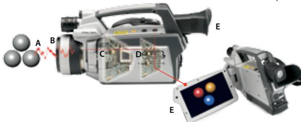
La termografía de infrarrojos es el arte de transformar una imagen de infrarrojos en una imagen radiométrica que permita leer los valores de temperatura. Por tanto, cada píxel de la imagen radiométrica es, de hecho, una medición de temperatura. Para ello se incorporan a la cámara termográfica algoritmos complejos.
