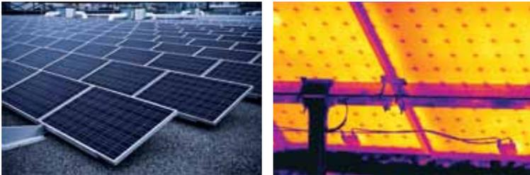
*El uso de cámaras termográficas para la evaluación de paneles solares ofrece varias ventajas. Las anomalías se pueden ver de forma clara en una termografía nítida y, a diferencia de la mayoría de los demás métodos, las cámaras termográficas se pueden utilizar para escanear paneles solares durante su funcionamiento normal.*
