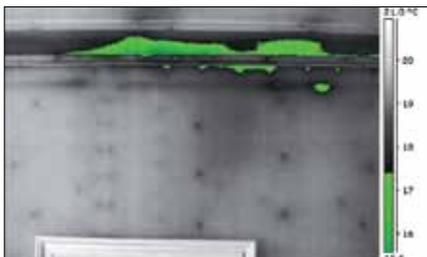
*La alarma de aislamiento muestra dónde se encuentran las áreas superiores o inferiores a una temperatura establecida indicándolas en un color diferente.*
