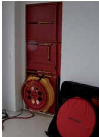
*El equipo de la "Puerta-ventilador" se instala normalmente en la puerta de entrada.*
