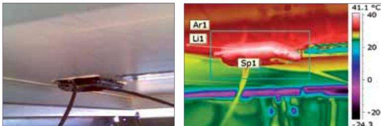
*Las cámaras termográficas de FLIR también se pueden utilizar para examinar los demás componentes de la instalación solar, como este conector defectuoso.*
