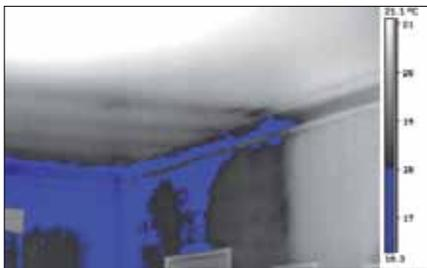
*La alarma de humedad relativa le alerta sobre las áreas en las que existe riesgo de condensación. En la imagen siguiente, se indica el área en riesgo en color azul.*
