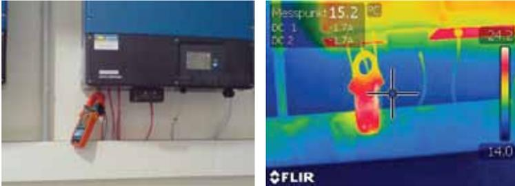
*Este inversor convierte la corriente continua de los paneles solares en corriente alterna. Las cámaras termográficas se pueden utilizar para inspeccionar este equipo. Un medidor de tenaza externo Extech puede proporcionar información adicional.*
