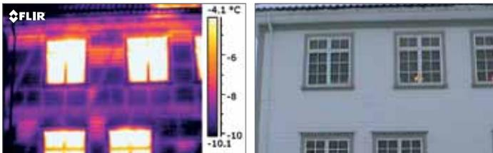
Estructura de la construcción. En muchas de las secciones se aprecia la falta de aislamiento según indican los colores más cálidos.
