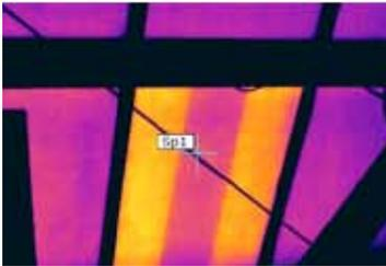
*Dos hileras de celdas aparecen calientes en la termografía, lo que indica que hay diodos de derivación rotos.*
