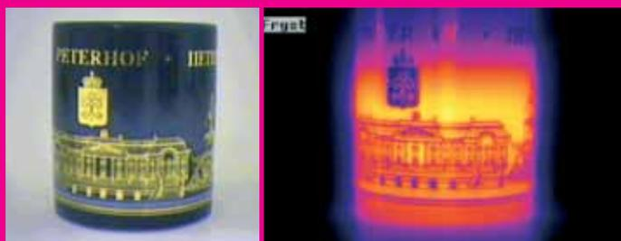
*Si observa la termografía, es posible que piense que la pintura dorada es más fría que la superficie de la taza. En realidad, tienen exactamente la misma temperatura, la diferencia en la intensidad de la radiación infrarroja está provocada por una diferencia en la emisividad.*
