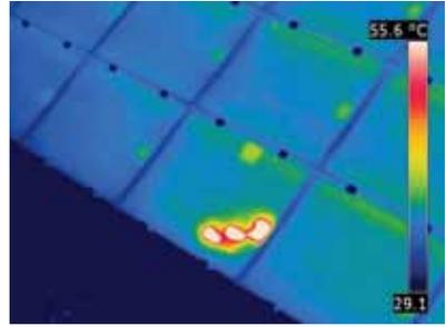
Termografía hecha con la cámara FLIR P660 en pleno vuelo sobre una granja solar. (Termograma cortesía de Evi Müllers, IMM)
