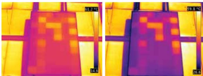
*Termografía con el nivel y el intervalo en modo automático (izquierda) y en modo manual (derecha).*
