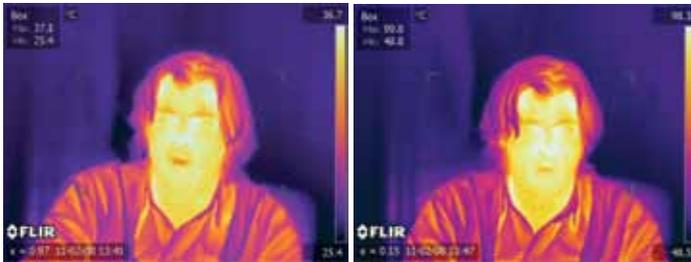
La termografía de la izquierda tiene la configuración de emisividad correcta para la piel humana (0,97) y la lectura de temperatura muestra la temperatura correcta (36,7 °C). En la termografía de la derecha se ha especificado una emisividad incorrecta (0,15), lo que genera una lectura de temperatura falsa (98,3 °C).
