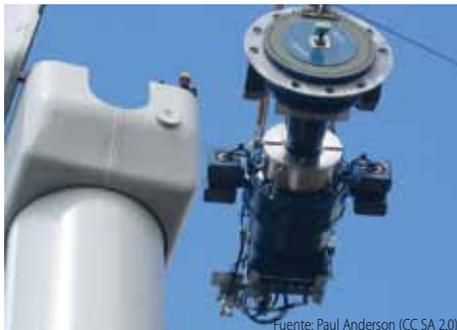
*Este enorme conjunto de caja de engranajes y freno de disco de 12 toneladas se eleva con una grúa a una altura de 60 metros para colocarlo dentro de la góndola de la turbina eólica.*
