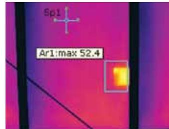
*Esta termografía muestra un punto caliente provocado por la rotura de celdas en una placa estándar de 60 celdas.*
