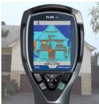
*FLIR i3, temperatura en 3.600 puntos*
