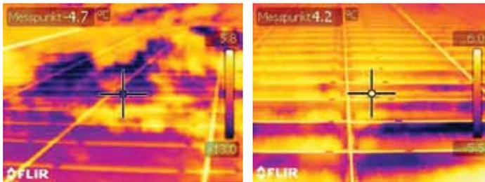
*Esta termografía muestra claramente que la reflexión puede ser un problema. La cámara termográfica muestra la termografía, incluyendo los reflejos provocados por la nube. A la hora de realizar mediciones de la reflexión, la temperatura aparecerá como una mezcla de la temperatura del panel y de la temperatura aparente reflejada de la nube.*
