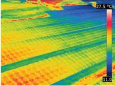
Para no obtener conclusiones erróneas, a la hora de inspeccionar paneles solares, necesita mantener la cámara termográfica en un ángulo correcto.
