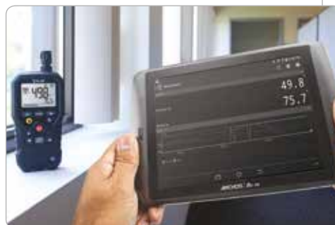
MR77 transmitiendo datos a una tablet Android via FLIR Tools Mobile.
