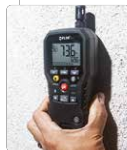
El modelo FLIR MR77 integra un sensor de humedad sin clavija y una sonda de clavija con cable.
