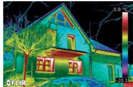
Las cámaras termográficas son excelentes herramientas para verificar si las reparaciones efectuadas en el aislamiento son eficaces.
