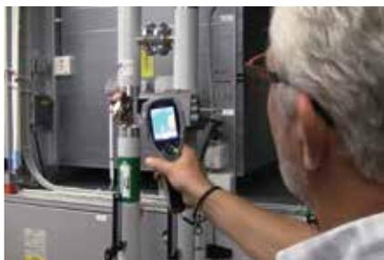
*Björn Blomgren muestra el uso de la cámara termográfica de FLIR.*
