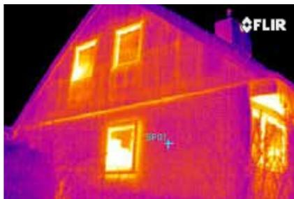
*Esta termografía muestra un ejemplo de fallo de aislamiento interno en un edificio residencial que se utiliza en el curso de termografía de Rockwool.*
