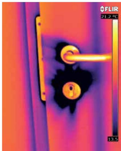
Fuga de aire durante la inspección de puerta-ventilador.
