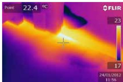
La termografía muestra claramente que hay una tubería de agua caliente debajo del suelo con una fuga.
