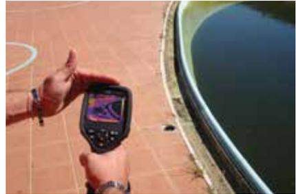
La cámara termográfica de FLIR localiza de forma clara las fugas de agua.
