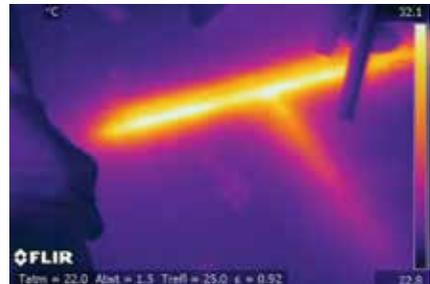
Esta termografía muestra dónde se ha instalado la tubería de agua caliente bajo el suelo.
