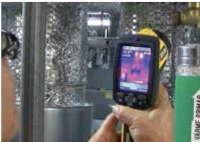
*Las cámaras termográficas de FLIR se pueden utilizar para detectar cantidad de diferentes problemas de construcción relacionados con el calor.*
