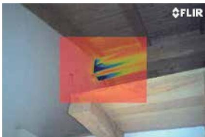
Fuga de aire durante una inspección de puerta-ventilador, Imagen-en-imagen.
