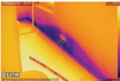
En este caso, en el que hay daños causados por el agua, se muestran claramente las ventajas de la función Imagen-en-imagen, ya que el cliente puede ver fácilmente dónde se ha tomado la termografía, dato que sería mucho más difícil de conocer únicamente con la termografía.
