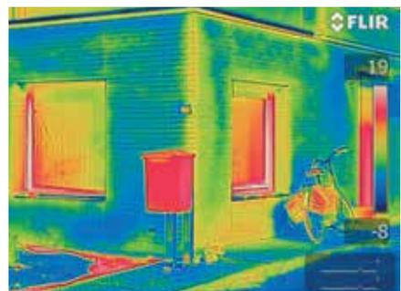
*Termografía del mismo edificio, pero con la tecnología MSX incorporada. Observe que hay más detalles visibles, por lo que resulta más fácil localizar las rejillas de ventilación y ver la estructura de los ladrillos.*
