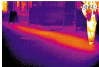
Las cámaras termográficas hacen que las tuberías subterráneas de una red de calefacción urbana sean claramente visibles. Las fugas de la red se pueden detectar fácilmente
