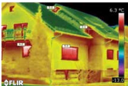
una cámara termográfica de FLIR se pueden medir de forma precisa las temperaturas de varios lugares con una sola termografía.
