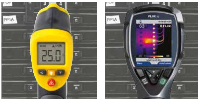
Termómetro infrarrojo, la temperatura en un solo punto FLIR i3, la temperatura en 3.600 puntos
