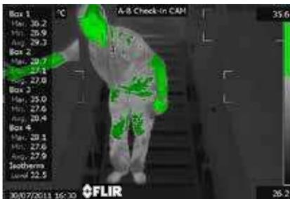
Si una región de interés (ROI) alcanza la temperatura umbral, la alarma empieza a sonar.
