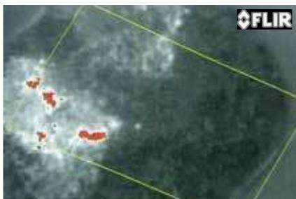
Las cámaras termográficas de FLIR Systems son las cámaras preferidas para la detección y prevención de incendios en depósitos de residuos sólidos
