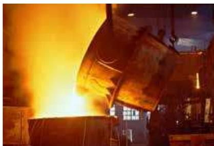
Las cámaras termográficas pueden detectar puntos calientes en la olla que advierten de un error mucho antes que una inspección visual. Esto permite retirar las ollas del servicio antes de que se produzca un accidente.
