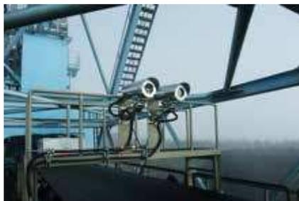
Cámaras termográficas de FLIR, montadas en carcasas protectoras, sobre las cintas transportadoras de carbón.
