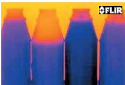
La termografía muestra botellas que se rellenan automáticamente. Las botellas que están rellenas por encima o por debajo del nivel se pueden retirar.
