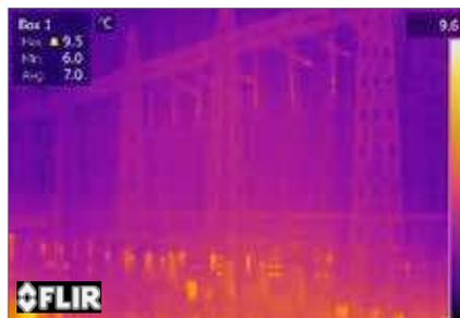
Cuatro cámaras termográficas supervisan los componentes más importantes de la subestación. Si alguno de los puntos que están en el campo de visión de la cámara detecta una temperatura superior a la temperatura umbral determinada previamente, se activará una alarma.
