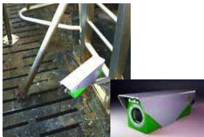
Para proteger la cámara FLIR A310 frente a las condiciones adversas de una granja lechera, las cámaras están montadas en una carcasa impermeable con sistema automático de limpieza de ventanas.
