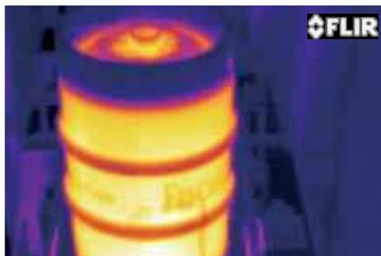
Un barril lleno de lejía tiene una temperatura superior que otro lleno de cerveza. Gracias a la termografía resultó fácil identificar los barriles con un contenido incorrecto mediante la medición de su temperatura.
