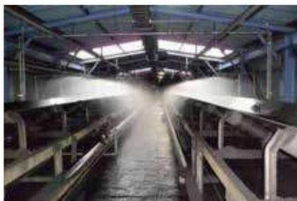
El PLC detiene inmediatamente la cinta transportadora y activa el sistema de rociadores cuando se activa la alarma de temperatura.
