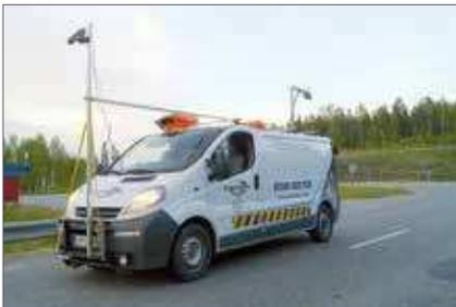
Este dispositivo especial para comprobar puentes incluye una cámara termográfica de FLIR con una lente de gran angular de  $90^{\circ}$ .
