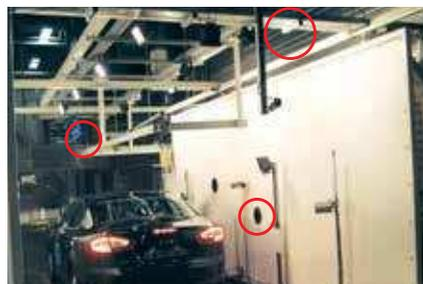
Ford Genk tiene tres cámaras termográficas de FLIR para realizar comprobaciones sobre la temperatura del sistema térmico del parabrisas delantero y trasero y del sistema del aire acondicionado. Las ubicaciones de las cámaras termográficas se marcan en rojo.
