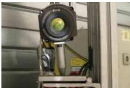
La cámara termográfica de FLIR se utiliza para comprobar el funcionamiento del sistema de aire acondicionado.
