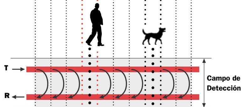
Cuando un blanco entra al campo de detección, el cable receptor recibe la señal alterada en el campo afectado y la transmite al procesador. El procesador analiza la fase y la amplitud de la señal alterada y compara esto con el umbral calibrado.
