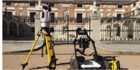
Sistemas **LIDAR**, capaces de realizar una digitalización 3D de la escena mediante una nube de puntos georreferenciada tanto en exteriores como en interiores.
