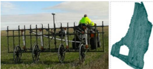
Por otro lado, contamos con **Magnetómetros** de nuestro socio tecnológico Sensys, ofreciendo gradiómetros basados en sistemas multisensor o magnetómetros triaxiales como el FGM650 ARCH o el FGM3D. Mientras que el FGM650 ARCH tiene un rango de medición reducido para resoluciones mejoradas, el FGM3D permite el análisis también de componentes magnéticos horizontales.
