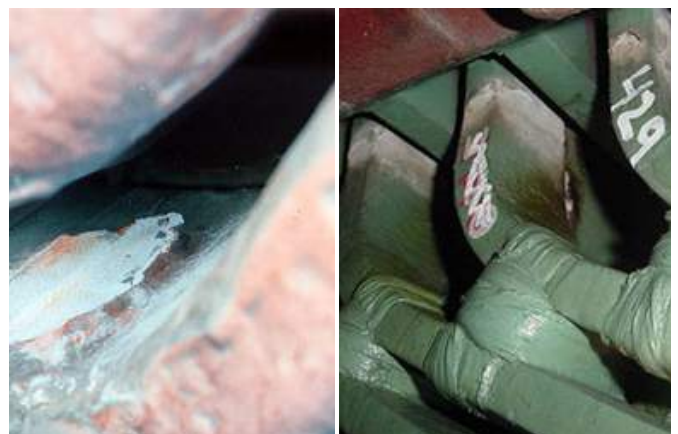
Figura 3. Actividad de Descargas Parciales en la salida de ranura.
