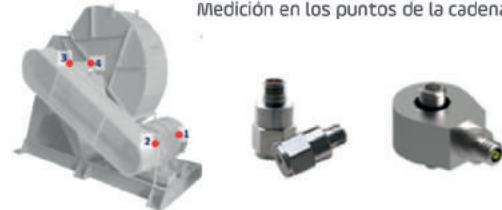
Medición en los puntos de la cadena cinemática
