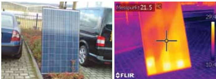
Una prueba en un panel solar muestra que los puntos calientes se pueden ver fácilmente en la termografía, incluso si dicha termografía es de la parte delantera.
