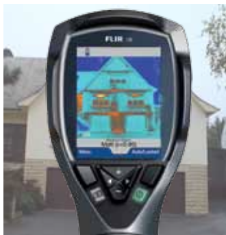
FLIR i3, temperatura en 3.600 puntos
