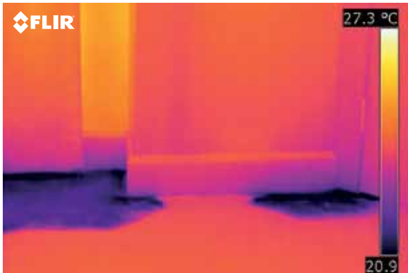
Filtración de humedad en el suelo, imposible de ver a simple vista, pero visible con claridad en la termografía.
